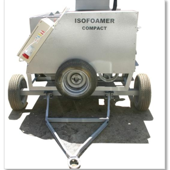
تنتج مجموعة ايزوفومر كومباكت الطين الاسمنتي المؤلف من اسمنت وماء أو اسمنت ورمل وماء بالكثافة المطلوبة للحصول على الانتاج النهائي من الخرسانة الرغوية، وتضخه الى السطح المطلوب صبه بواسطة المضخة المجهزة بها:
