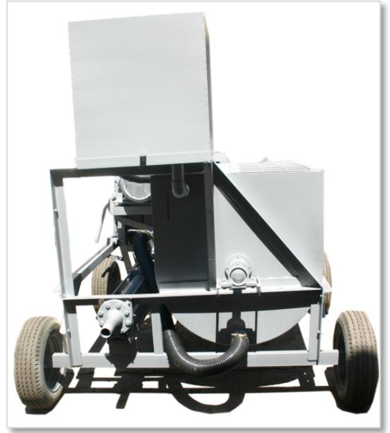
عند وصلها بمنتج الرغوة ايزوفومر انفينيتي (صورة ٤)، تنتج ايزوفومر كومباكت الخرسانة (الباطون) الرغوية الخفيفة الوزن و تنقلها بواسطة المضخة الى ارتفاع ١٢٠ مترا .
